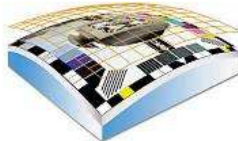
Die bauartbedingte Krümmung konventioneller Monitore verursacht ein konvexes Bild
